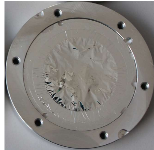
Al layer 87nm Physical vapour deposition CEA
